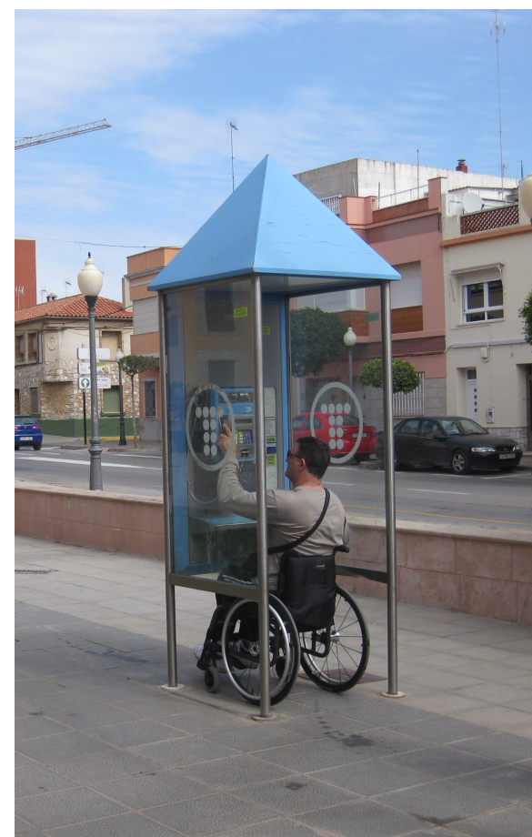
Imagen 34: Cabina de teléfonos con altura inaccesible para usuarios en silla de ruedas
