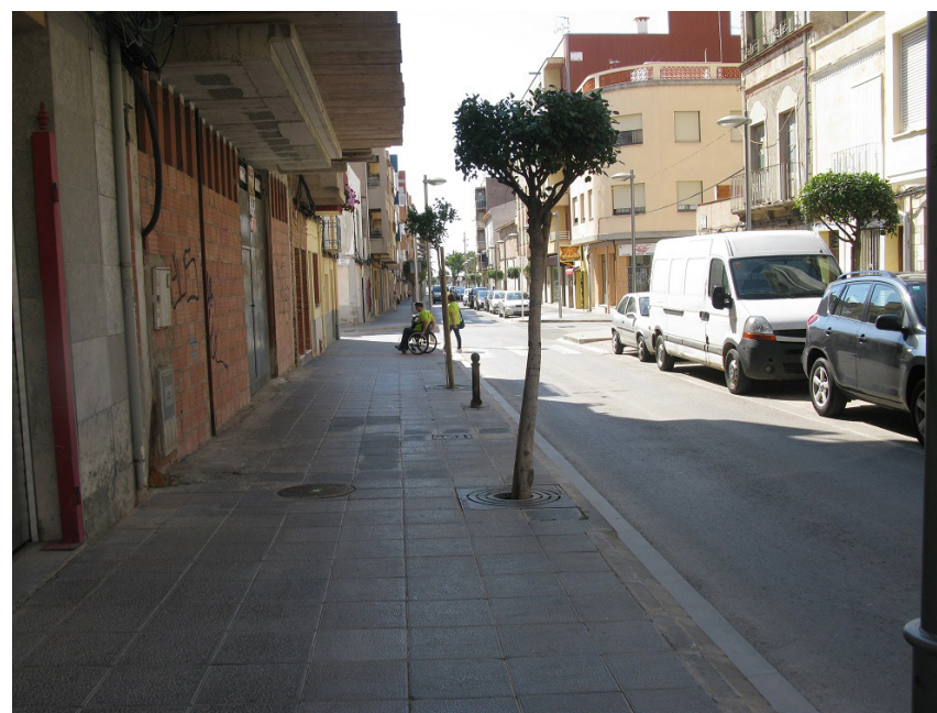
ITINERARIO PEATONAL_ Mayormente accesible: aceras anchas, sin desniveles aislados y con una altura y diseño de bordillo adecuado en la mayoría del recorrido. La pendiente es uniforme en prácticamente todo el itinerario, siendo las longitudinales inferiores al 6 % alcanzando un máximo del 4 % y la transversal del 0,6 %.
